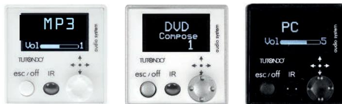
Comando remoto a controllo digitale, permette la selezione delle sorgenti audio e la regolazione dei parametri audio d'ambiente.
