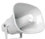
Per uso esterno (Tipo B) IP66. Potenza regolabile (30 / 15 / 7,5 / 3,75 W). Completo di morsetti ceramici.
