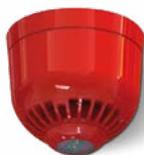
Parte ottica certificata secondo la nuova norma EN54-23 completo di base di montaggio. Tono selezionabile tra i 32 disponibili mediante DIP switch interno, frequenza di lampeggio 0,5Hz / 1 Hz (selezionabile mediante DIP SWITCH), volume selezionabile tra 2 livelli.
