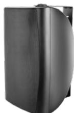
Diffusore acustico due vie da parete (speaker da 5", tweeter da 1.5"). Montaggio superficiale mediante la staffa metallica di fissaggio inclusa, orientabile, contenitore plastico in ABS resistente alla fiamma, griglia metallica per la protezione della parte a vista. Supporta linee a 70 V o 100 V, tramite selettore può essere impostato per erogare una potenza di 7.5 / 15 / 30 W.
