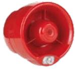
I segnalatori di allarme via radio per montaggio a parete delle serie WS20x0 sono compatibili con i traslatori Indirizzati EWT100 o le espansioni XWT100. Nelle varie versioni dispongono di un segnalatore acustico con 32 toni selezionabili, lampeggiatore a luce bianca, disponibili in contenitore plastico rosso o bianco.
