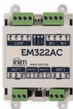
Si collega al Loop e dispone di due ingressi supervisionati (in grado di controllare lo stato di un dispositivo esterno) e di due relè in grado di pilotare carichi a tensione di rete 230 V AC. Per ciascuno dei due relè di uscita è possibile attivare la funzione di supervisione che permette di controllare se, in condizioni di relè a riposo, ci sia tensione ai capi del contatto.
