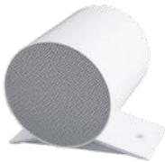
Per uso interno (Tipo A) IP21. Potenza regolabile (10 / 6 / 3 / 1,5 W). Corpo in alluminio. Completo di morsetti ceramici e fusibile termico.
