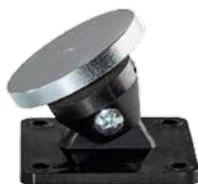
Le contropiastre della serie S01 utilizzano un disco in acciaio montato su un apposito ammortizzatore in grado di assorbire parte dell'impatto causato dalla porta in apertura. L'elasticità dell'ammortizzatore consente inoltre un perfetto accoppiamento del disco al magnete.
