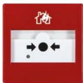
Pulsante di allarme ripristinabile, può essere collegato sul Loop e gestito dalle centrali antincendio analogico-indirizzate. Nella parte frontale del pulsante sono presenti la parte attiva per l'attivazione ed un LED che indica lo stato del dispositivo. Una volta attivato il pulsante può essere ripristinato mediante la chiavetta di ripristino fornita nell'imballo.
