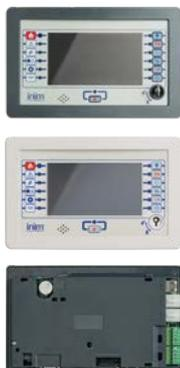
Unità di controllo principale, dotata di display grafico a colori con touchscreen 7" a 65000 colori. Si occupa della gestione della centrale e di coordinare i vari moduli funzione. Il modulo può inoltre essere utilizzato come tastiera Remota (Repeater) collegato alla linea RS485 della Centrale (max 14 Repeater in serie) o tramite rete TCP-IP. Se utilizzato come tastiera remota il modulo va abbinato al contenitore PRREP.
