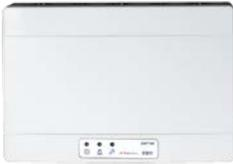
Viene riconosciuto sul loop come un dispositivo indirizzato Inim ed occupa, oltre al proprio, un indirizzo per ciascun dispositivo radio ad esso associato. Il traslatore può gestire in maniera diretta fino ad un massimo di 32 dispositivi via radio o, aggiungendo dei moduli di espansione XWT100 fino ad un massimo di 128 dispositivi. Si alimenta da Loop o da una fonte di alimentazione locale collegando un alimentatore 24 V.
