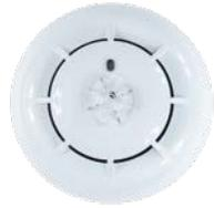
Il rivelatore può essere impostato nelle modalità: A1R (soglia fissa a 58°C e rivelazione termovelocimetrica), B (Soglia fissa a 72°C), A2S (Soglia fissa a 58°C), BR (soglia fissa a 72°C con rivelazione termovelocimetrica). Grazie alla sua alta versatilità si adatta a tutte quelle condizioni dove la rivelazione del fumo risulta difficile e suscettibile di falsi allarmi.
