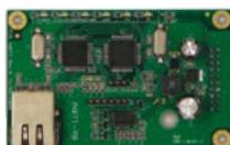
SmartLAN/SF permette la connessione ad una rete Ethernet rendendo possibile l'accesso da remoto attraverso Internet alla centrale ed a tutte quelle connesse in rete HorNet con essa. La scheda fornisce la possibilità di effettuare la programmazione (up-downloading) dei dati da remoto e di gestire il sistema tramite il software di controllo SmartLook. Implementa il protocollo Modbus su TCP-IP.
