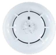
Il rivelatore può essere impostato nelle modalità: A1R (soglia fissa a 58°C e rivelazione termovelocimetrica), B (Soglia fissa a 72°C), A2S (Soglia fissa a 58°C), BR (soglia fissa a 72°C con rivelazione termovelocimetrica). Grazie alla sua alta versatilità può essere adattato a tutte quelle condizioni dove la rivelazione del fumo risulta difficile e suscettibile di falsi allarmi.
