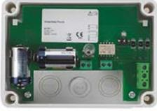
Il modulo di uscita WM202SR è dotato di una uscita relè (contatto pulito) ed una uscita supervisionata in grado di fornire una tensione di 12 o 24 V DC partendo dalla batteria interna. Il modulo è completamente gestito da centrale (se abbinato con centrali indirizzate).
