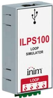
Si collega ai morsetti di Loop delle centrali Inim e simula fino a 240 dispositivi, permette di testare il funzionamento di un loop, verificare la configurazione e le logiche di attivazioni cause/effetto in maniera agevole senza dover collegare fisicamente i dispositivi. Si collega ad un PC tramite la porta USB (elettricamente disaccoppiata per non interferire con la centrale e generare difetti di terra) e grazie al software "ILP Simulator" è possibile:
