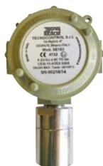
Sono dotati di interfaccia 4-20 mA con fondo scala pari al 20% L.I.E (Versione K) o fondo scala pari a 100% L.I.E. (Versione P) per i rivelatori di gas esplosivi e di 300 ppm per il rivelatore di CO. Il rivelatore prevede una pratica operazione di verifica, calibrazione e test elettrico utilizzando i due tasti presenti sul circuito, il gas titolato delle bombole di test può essere applicato sull'elemento sensibile tramite gli adattatori TC011 o TC014.
