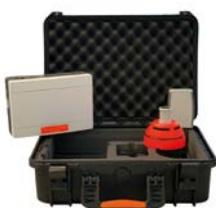
La valigetta è composta da: un trasmettitore di test, un rivelatore di test, un adattatore Bluetooth e un trasmettitore via radio per comunicazione con APP Android. Il kit permette di eseguire di test di posizionamento e valutare il segnale radio prima di procedere all'installazione del sistema. Il valore del segnale radio trasmesso dal rivelatore di test ed i Trasmittitore di test può essere visualizzato sull'app per sistemi android (Smartphone-tablet) scaricabile dallo store.
