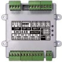
Il modulo si collega al Loop e mette a disposizione diversi ingressi e uscite a seconda del modello (vedi tabella). Nelle versioni equipaggiate con 4 ingressi 2 di questi possono essere configurati come zone convenzionali o ingressi 4-20 mA, alimentate dal Loop o da una fonte di alimentazione locale. Le 4 uscite sono, a seconda del modello, supervisionate per la gestione di segnalatori ottico acustici o dei contatti puliti.
