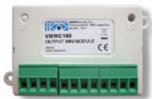
I moduli della serie Argus permettono di supervisionare lo stato di dispositivi esterni (moduli di ingresso) o di controllare dispositivi o attuatori esterni (Moduli di uscita). I moduli includono un isolatore di corto circuito e sono disponibili nella versione Mini (96 x 52mm) o da parete (86 x 86 mm)
