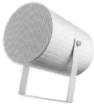
Diffusore acustico tipo proiettore. Montaggio mediante la staffa metallica di fissaggio inclusa, orientabile, contenitore in alluminio, griglia metallica per la protezione della parte a vista. Supporta linee a 70 V o 100 V, tramite selettore può essere impostato per erogare una potenza di 5 / 10 / 20 W.
