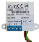
Grazie alle dimensioni ridotte può essere alloggiato direttamente all'interno del dispositivo da controllare (Pulsante di allarme, sirena, rivelatore lineare ecc.), si collega al Loop e dispone di un ingresso supervisionato (per controllare lo stato di un dispositivo), di una uscita alimentata direttamente dal Loop (per pilotare un dispositivo di segnalazione acustico o ottico/acustico).
