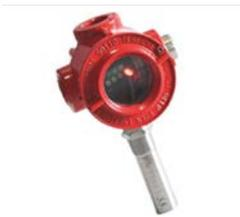
Rivelatore di temperatura ad assorbimento (per centrali convenzionali) serie TMP2-JO e TMP2-TO, custodia antideflagrante certificata ATEX. Reset automatico. Certificazione ATEX II 2G Ex d IIC T6
