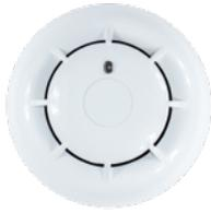
Basato sull'effetto Tyndall (diffusione della luce) il rivelatore ID100 è in grado di dare una risposta rapida ed efficace al primo insorgere di un focolaio d'incendio, in grado di rilevare una vasta gamma di particelle generate dalla combustione. Il design della camera, la sigillatura della parte superiore del rivelatore, la rete con maglie da 500 micron contro l'ingresso degli insetti garantiscono una eccezionale reiezione ai falsi allarmi.
