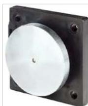
Le contropiastre della serie S02, SH2, S00 utilizzano un disco in acciaio montato su un apposito ammortizzatore in grado di assorbire parte dell'impatto causato dalla porta in apertura. L'elasticità dell'ammortizzatore consente inoltre un perfetto accoppiamento del disco al magnete.
