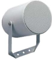
Diffusore acustico tipo proiettore. Montaggio mediante la staffa metallica di fissaggio inclusa, orientabile, contenitore plastico in ABS resistente alla fiamma, griglia metallica per la protezione della parte a vista. Supporta linee a 70 V o 100 V, tramite selettore può essere impostato per erogare una potenza di 5 / 10 / 20 W.
