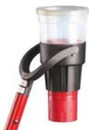
Può alloggiare al suo interno una bomboletta modello SOLO A10 e SOLO A10S (non inclusa) e permette l'erogazione dell'aerosol sopra il rivelatore con una semplice pressione esercitata dal basso verso l'alto. Abbinato alle prolunghe telescopiche riportate di seguito permette di eseguire il test dei rivelatori posizionati fino a 9 m di altezza.
