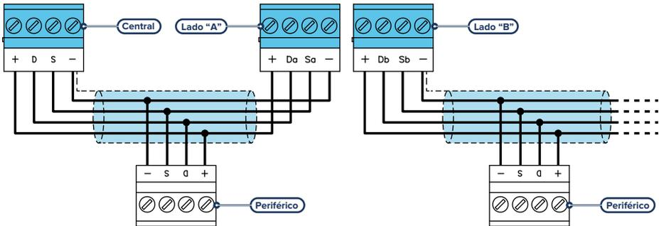
Os periféricos das centrais Inim Electronics devem ser conectados à unidade central através do I-BUS. A conexão entre a central e seus periféricos é feita mediante um cabo blindado de 4 (ou mais) fios.
