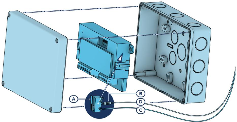
Os periféricos com os terminais à vista e que não dispõem de uma proteção anti-sabotagem podem ser dotados, de qualquer modo, de uma proteção intervindo no procedimento de montagem.
